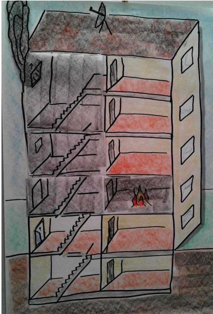
Abbildung 6: Verrauchter Treppenraum mit Abluft
