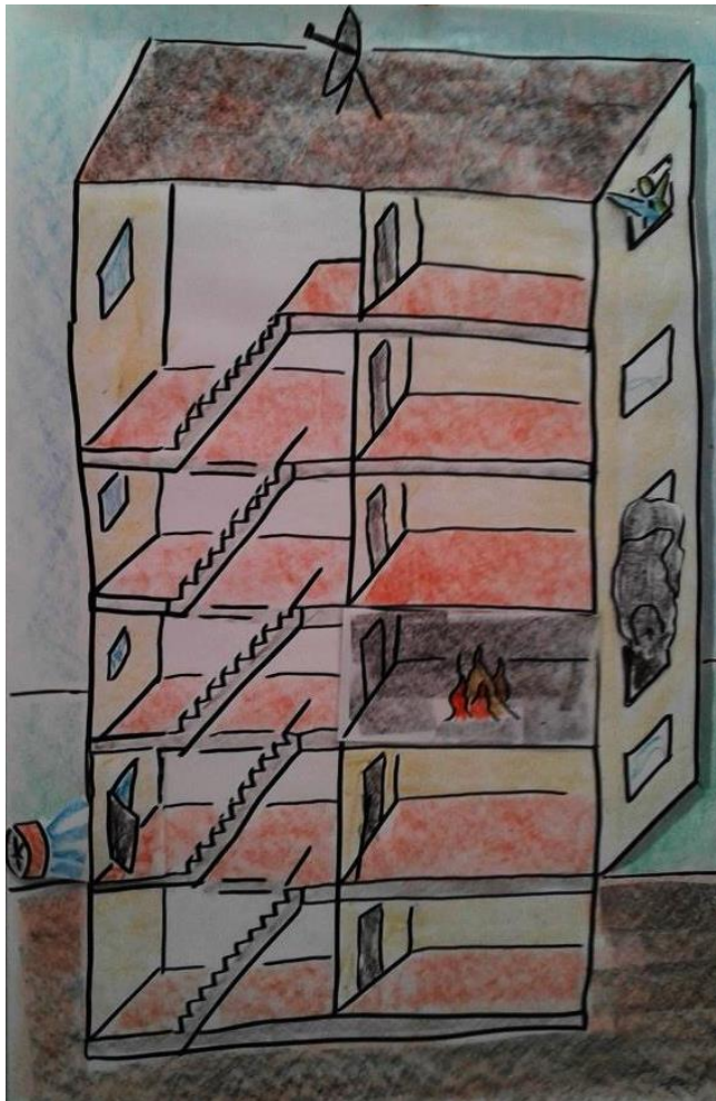
Abbildung 4: Wohnungsbrand 1. OG mit Lüfter
